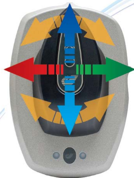
Функциональность сдвоенной водометной установки - выше Функциональность одинарного исполнения - снизу
